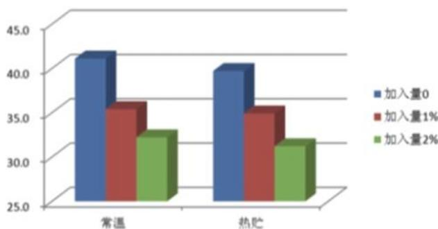
\*测试结果: 增效剂 H-8380 大幅度降低表面张力,且在制剂配方中稳定。
